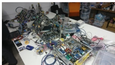
図2 民生品を多用した搭載電子装置
